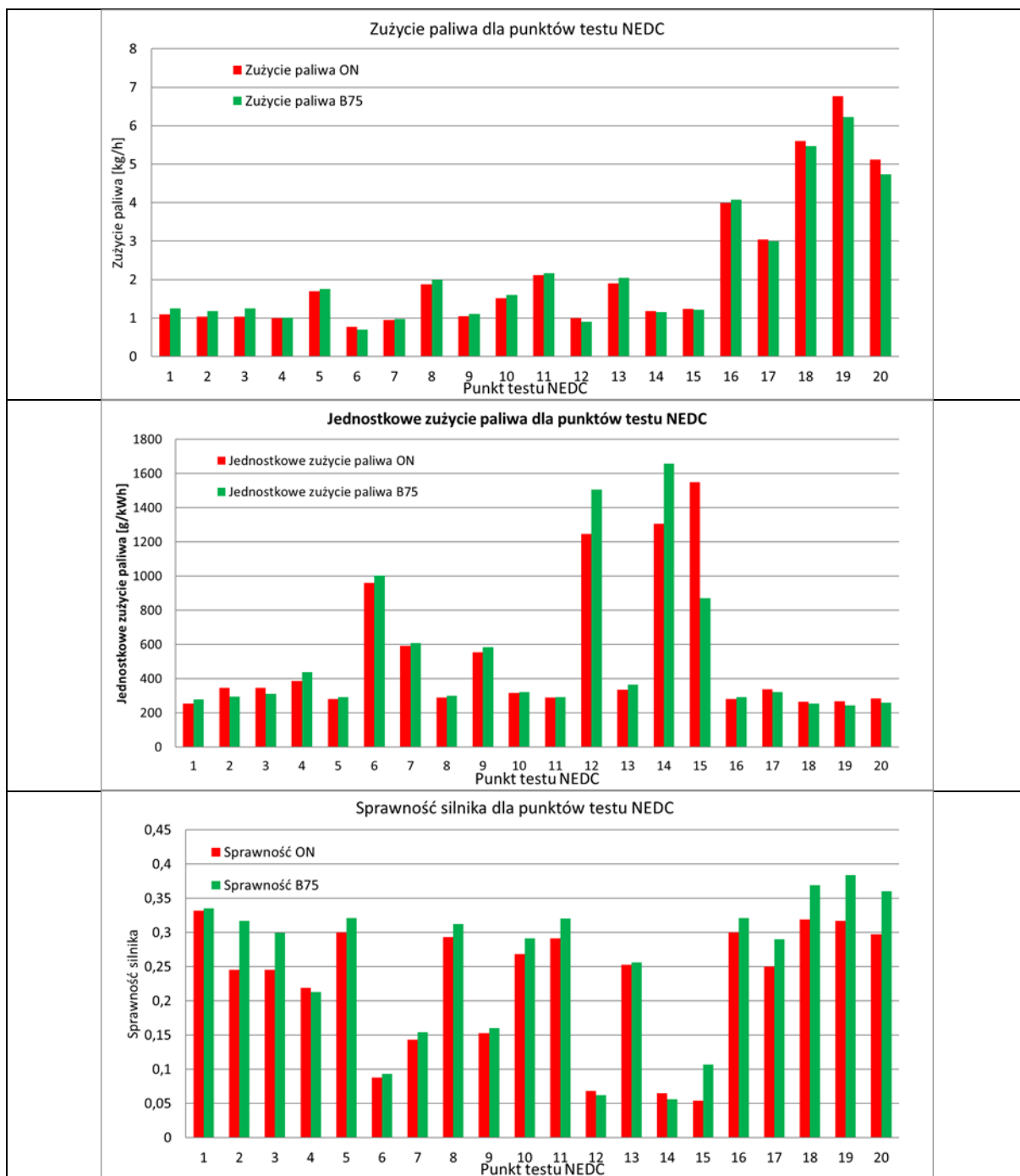
Rys. 3. Wyniki pomiarów zużycia paliwa oraz sprawności silnika zasilanego biopaliwem B75 i ON podczas testu NEDC
